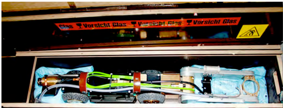
BU: Hochwertiger Roboter für ferngesteuerte Arbeiten im Kanal für den Transport sorgfältig verpackt.
